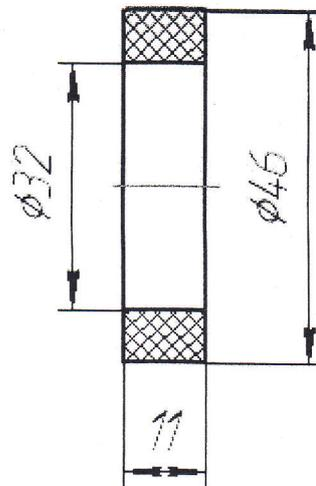
1. Предельные отклонения размеров диаметров  $H14, h14$ , остальных  $\pm \frac{IT14}{2}$
